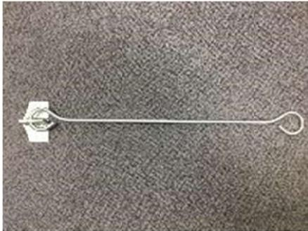
ハウスの吹きあがり防止に、簡単に後付けできる補強杭です。6mピッチに入れることで、引抜き強度が60%UPします。専用の打ち込み金具を使ってハウスアンカーを設置し、ワイヤーをハウス内側に通すだけなので、施工も簡単です。
